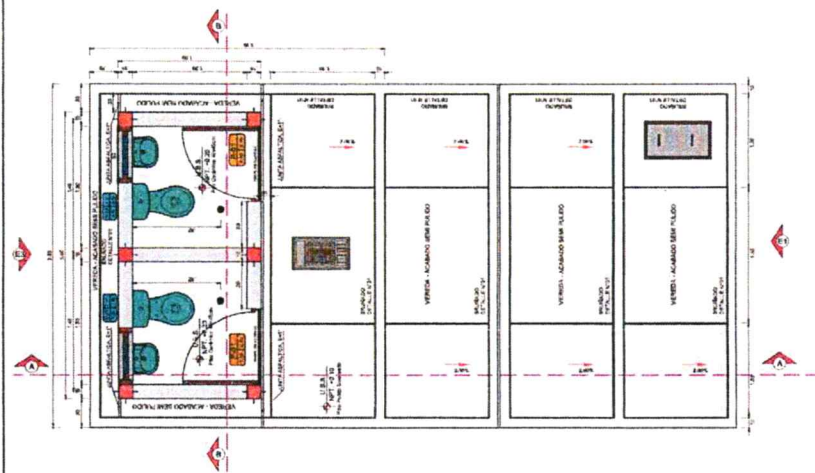
PLANO EN PLANTA DE LA UNIDAD BÁSICA SANITARIA Escala 1:25
